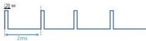
PMW con duty cycle del 1%
